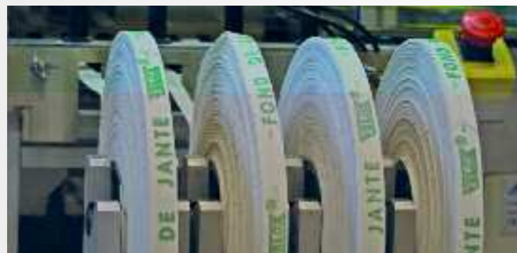
Machine à fabriquer les fonds de jantes en petits rouleaux avec trou de valve (dans nos locaux à argenteuil, France)
